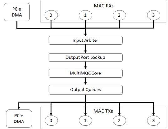
Fig. 8. FPGA modules overview
